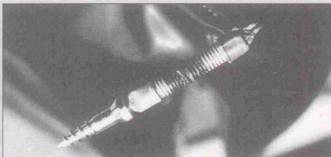
Bild G. Eine durchgebrannte Entstörpatrone aus einem Zündkerzenstecker – ein häufiger Fehler in neuzeitlichen Hochleistungszündanlagen. Die induktiven Komponenten solcher Widerstandsdrahtwendel ( L = 0,1...15 \mu H ) tragen noch wesentlich zur Fahrzeugentstörung bei.
